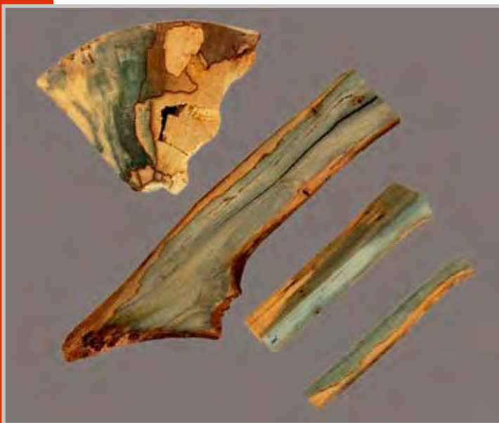
Durch Pilzbefall grün verfärbtes Holz Foto: Massimo Behring und Christine Cornet
