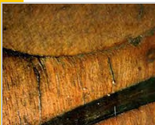
Abb. 10 Seitlich verquetschte Holzfasern am Grundfurnier zeigen ebenfalls die Verwendung des Schultermessers. Foto: Katrin Prem
