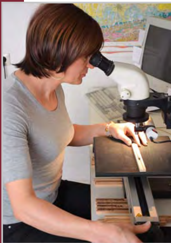
Einmessen einer Holzprobe unter dem Mikroskop
