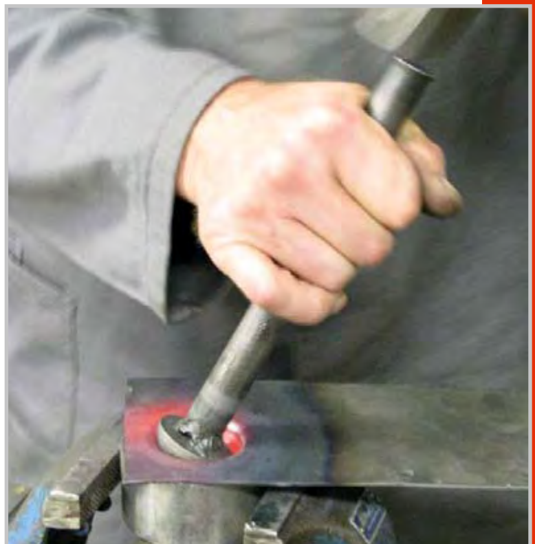
In der Metall-Werkstatt: Treibvorgang für die Halbkugelabdeckung eines Schlosses. Foto: Clemens Pawelski
