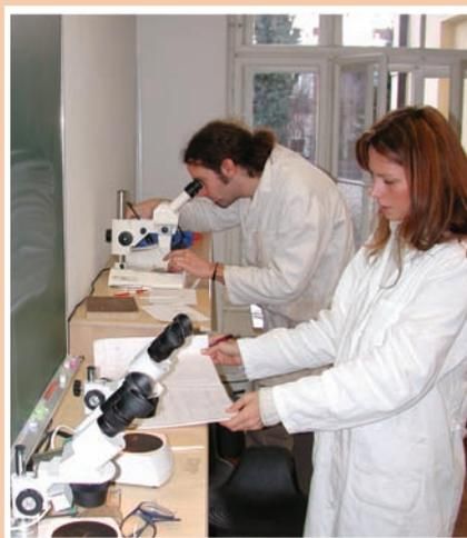
Untersuchungen der Rückstände der Glühprobe z.B. auf Farbveränderungen bzw. Schmelzprodukte unter dem Mikroskop.
