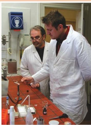
Arbeiten im chemischen Labor: Vorversuche durch Glühen von kleinsten Probenmengen zur Pigmentbestimmung.
