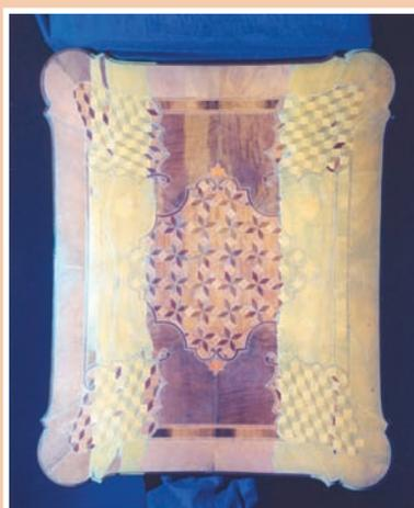
Tischblatt nach der Rekonstruktion im UV-Licht. Deutlich sind die originalen Fragmente von den ergänzten Partien zu unterscheiden.
